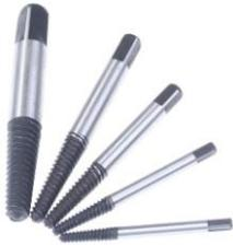
esistono degli appositi estrattori nell'industria meccanica (si trovano anche da un buon ferramenta) chiamati appunto "estrattori per bulloni" o più tecnicamente "estrattori conici sinistrorsi autofilettanti", ce ne sono varie misure in base al foro in cui si devono inserire, sono leggermente conici e presentano una filettatura nel verso contrario a quello abituale, cioè avvita al contrario, non costano molto.
